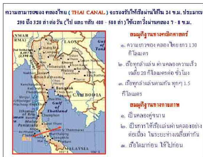
ภาพที่ 4 การคำนวณจำนวนเรือที่คลองไทยให้บริการ เรือผ่านได้
